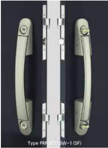
Model/ Mã số PGF713W(SF) Material Die-cast aluminum Chất liệu Nhôm đúc Finishes Stainless color painted Hoàn thiện Sơn chống gỉ Size (mm) 51x438 mm(RxD) Application 36-45mm door thickness range Ứng dụng Độ dày cửa 36-45mm
